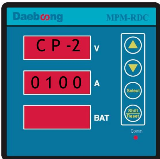
CP-2은 배터리에 설치 된 Shunt 저항의 입력 정격 전류를 설정하는 화면으로 설치 된 Shunt 저항의 정격 전류를 입력 하면 된다.
