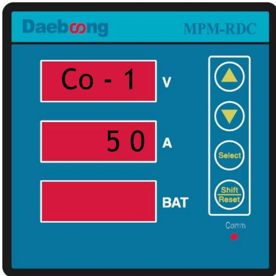
Co-1은 정류기반 Shunt 저항의 출력 정격을 설정하는 화면으로 설치 된 Shunt 저항의 정격 출력 값을 입력 하면 된다.
